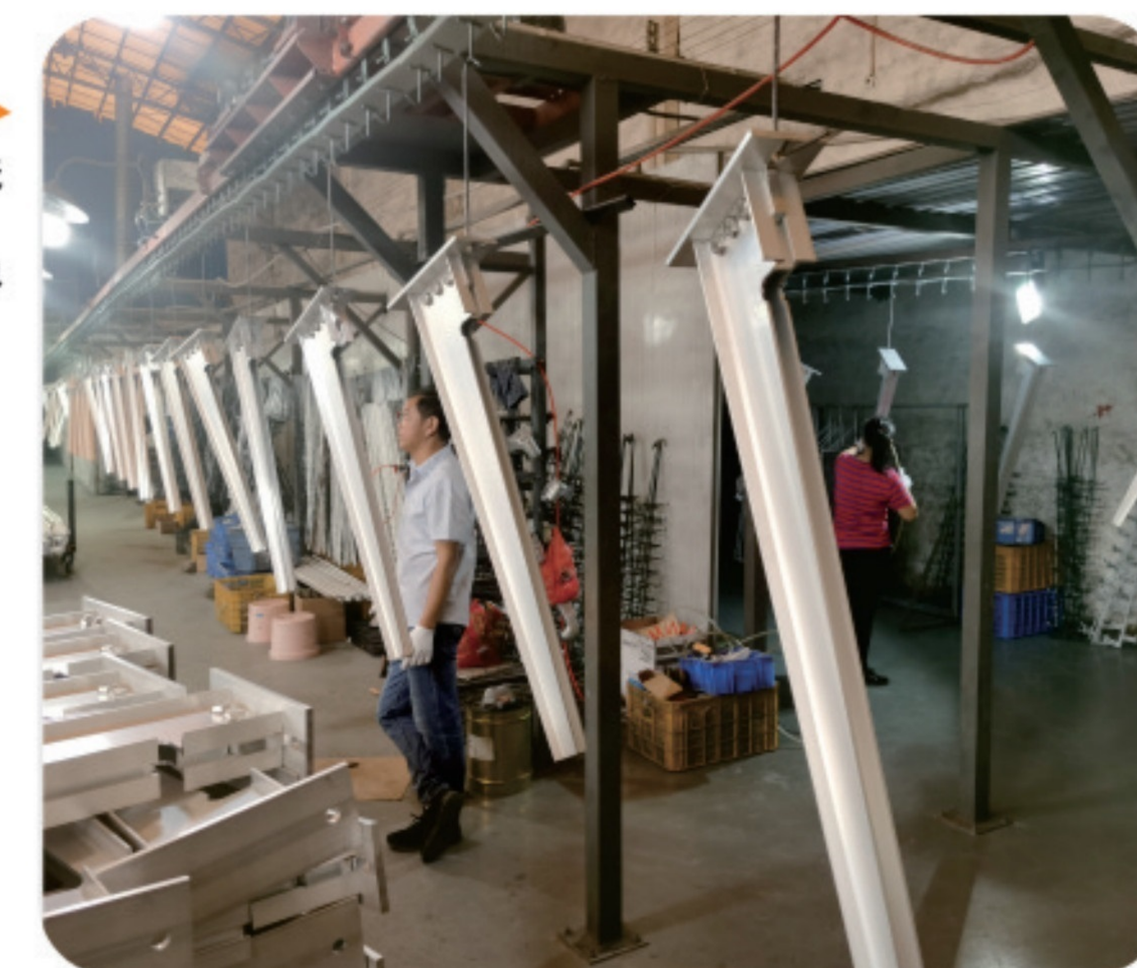
▶ 打磨清洗 喷涂 高温固色
